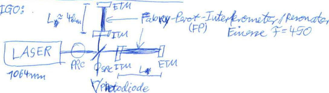
SRC: Signal-recycling cavity } weitere FP-Resonatoren
