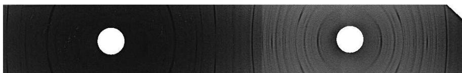
Abbildung 8: Probe 1, Aufnahme 3, mit Filter, Belichtungszeit: 60 min, Probe wurde vorher zum Glühen gebracht
